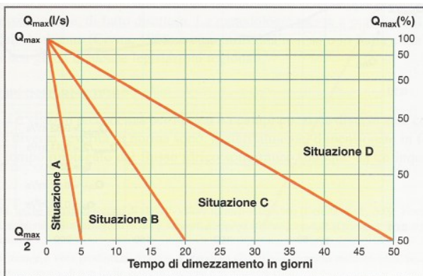
Fig.8 – Abaco per la determinazione della situazione di vulnerabilità in funzione del tempo di dimezzamento (da Civita, 2005)
