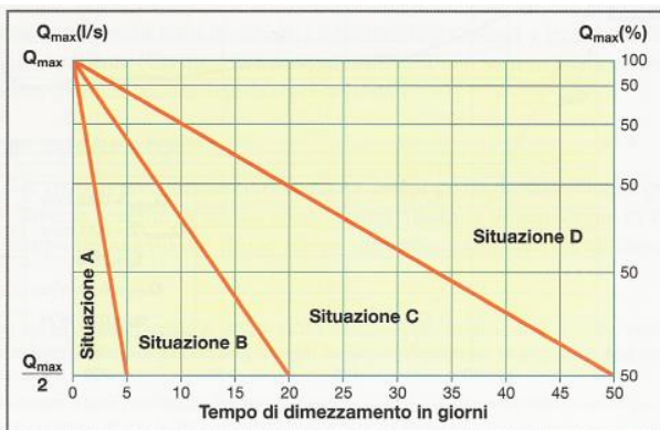
Fig.7.8 – Abaco per la determinazione della situazione di vulnerabilità in funzione del tempo di dimezzamento (da Civita, 2005)
